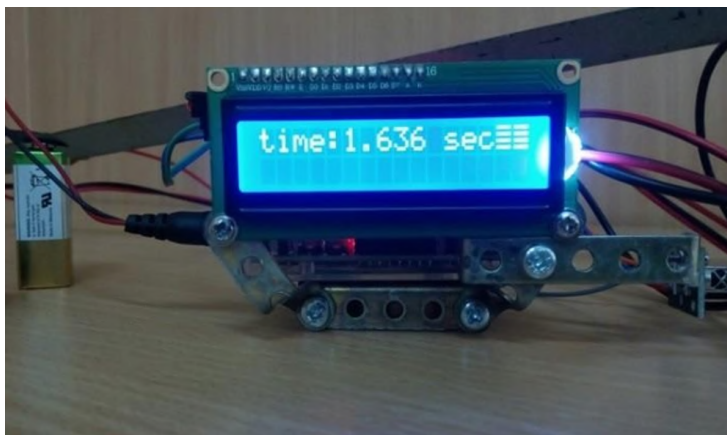
Рис. 1. Секундомір для вимірювання часу рівноприскореного руху
