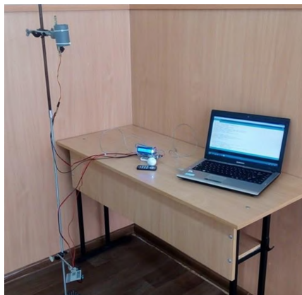
Рис. 4. Установка для дослідження прискорення вільного падіння
