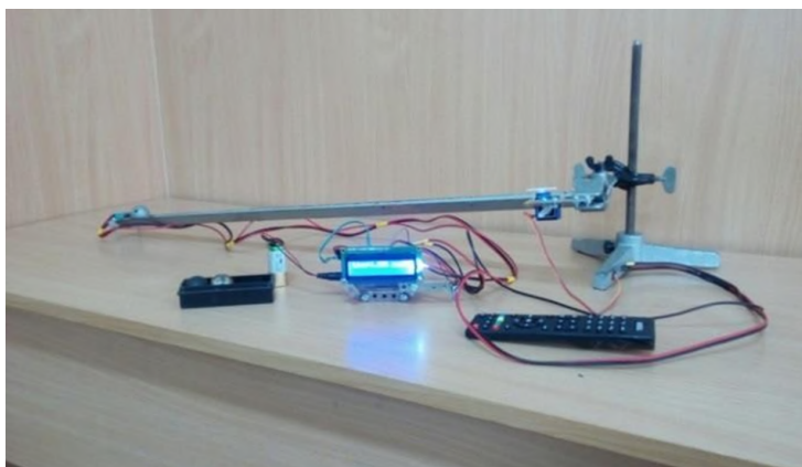
Рис. 2. Установка для вимірювання часу рівноприскореного руху
